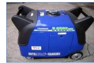
11. 発電機 (1台) インバーター式/出力2.8kVA
