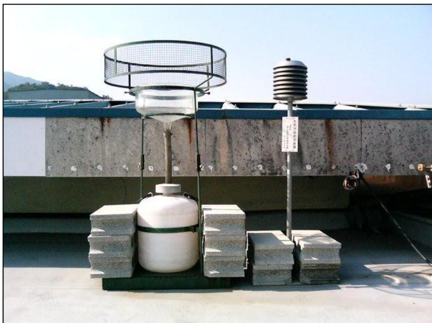
(写真左側の機器が、降下ばいじん試料採取機器、右側の機器が
