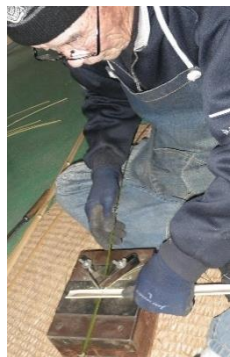
竹ひごの幅を均一にするための道具。福原さんの手作りです
